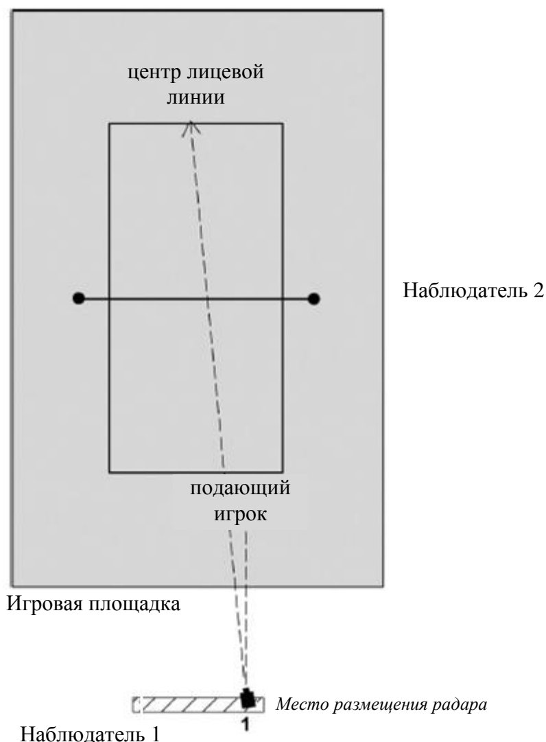
Рисунок 1. Оценка скорости полета мяча при подаче 1 - Радарная пушка
