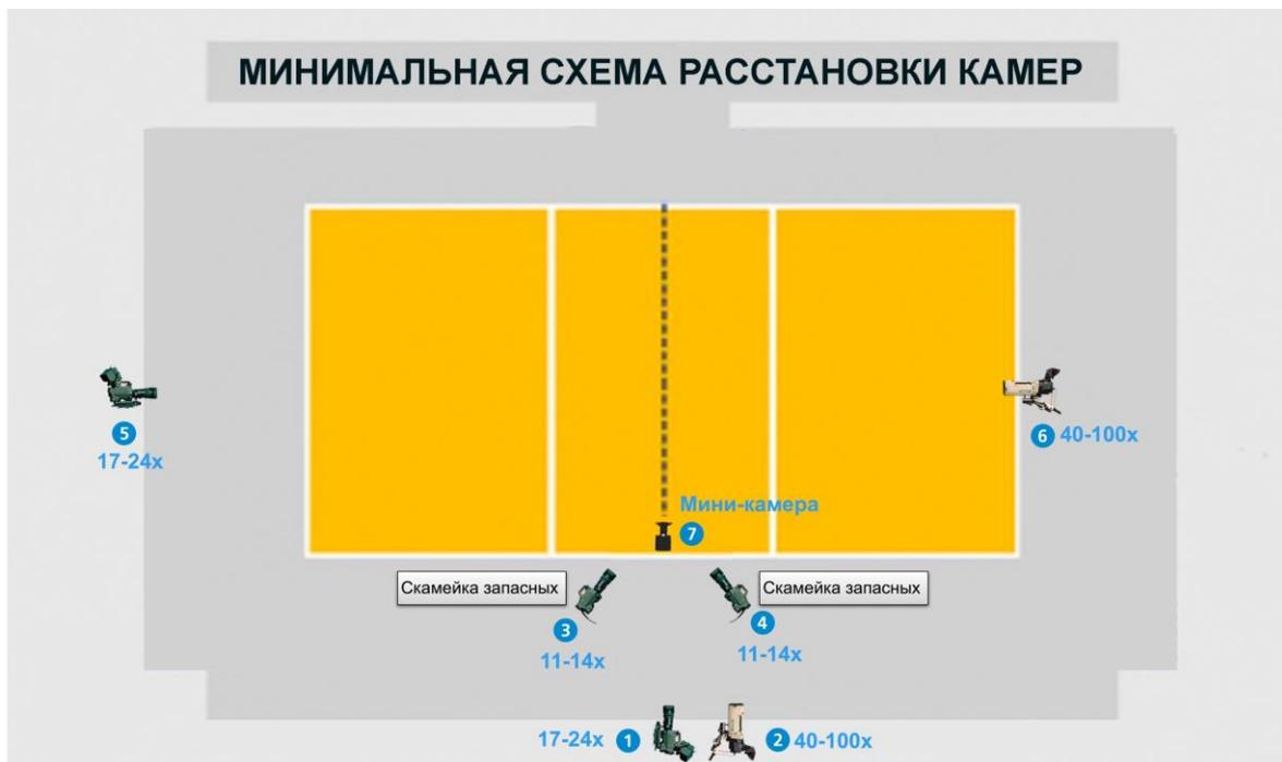
**Камера 1**- Ведущая камера со стандартным объективом , показывающая основной рисунок игры (на штативе с ручками управления фокусом и трансфокатором, и накамерным монитором). Стоит в верхней точке по линии волейбольной сетки.
